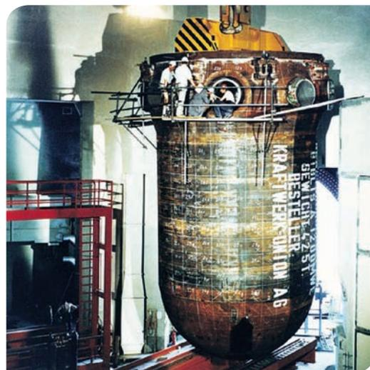
**Abb. 7.08** Reaktordruckgefäß eines Druckwasserreaktors
